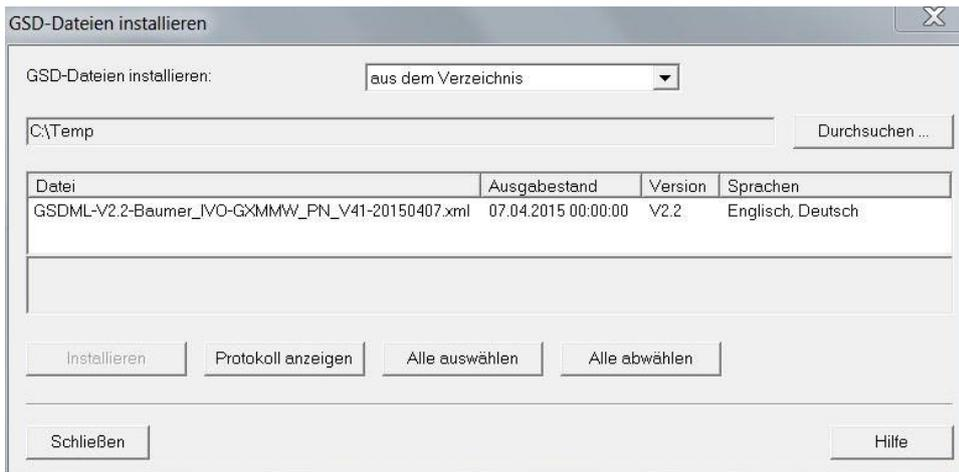
Der Drehgeber erscheint anschliessend rechts im Hardware-Katalog unter „PROFINET IO“ – „Weitere Feldgeräte“ – „Encoders“ – „Baumer IVO PROFINET Encoder“ - „Baumer IVO PROFINET Drehgeber“ – „GxxMW“ (xx je nach Drehgebertyp).
