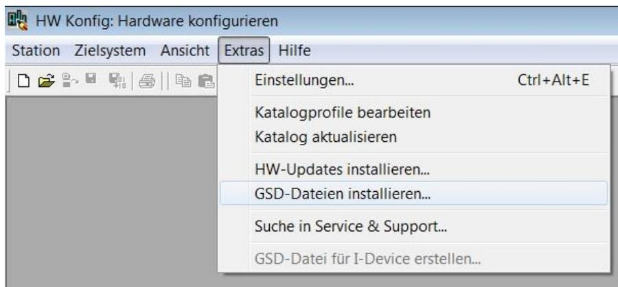
Im folgenden Dialog wählen Sie das Verzeichnis, in dem sich die zu installierende GSDML-Datei befindet. Die Datei wird angezeigt und kann nun markiert werden. Mit „Schliessen“ wird der Vorgang abgeschlossen. Im gleichen Verzeichnis befindet sich ebenfalls die zugehörige Bitmap-Datei, die im Projektierungstool den Drehgeber als kleines Bild darstellt. Diese wird automatisch mit installiert.
