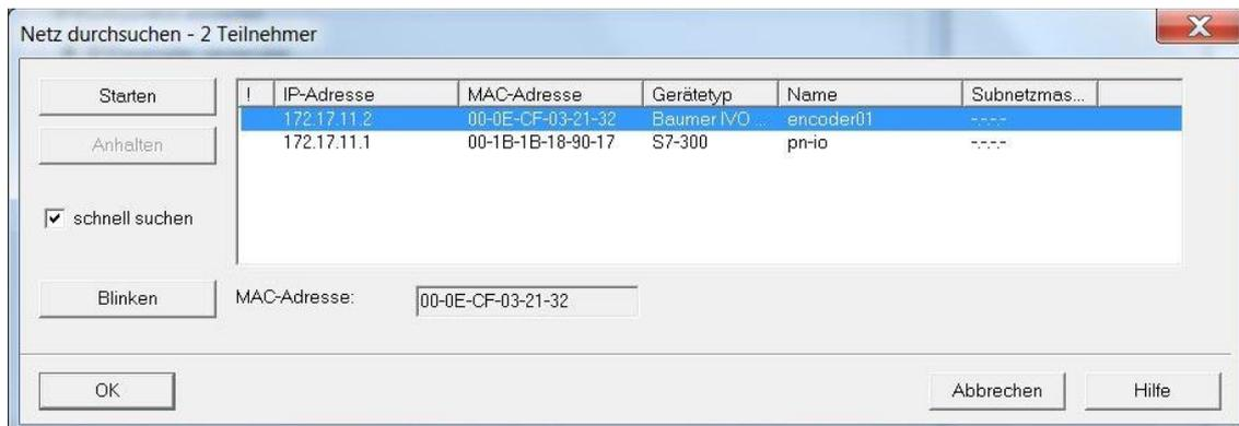
Zur eindeutigen Erkennung des Device dient die MAC-Adresse. Mit dem Button „Blinken“ kann einer der gefundenen Teilnehmer dazu gebracht werden, dass seine Status-LED blinkt um ihn in der Anlage besser identifizieren zu können.
