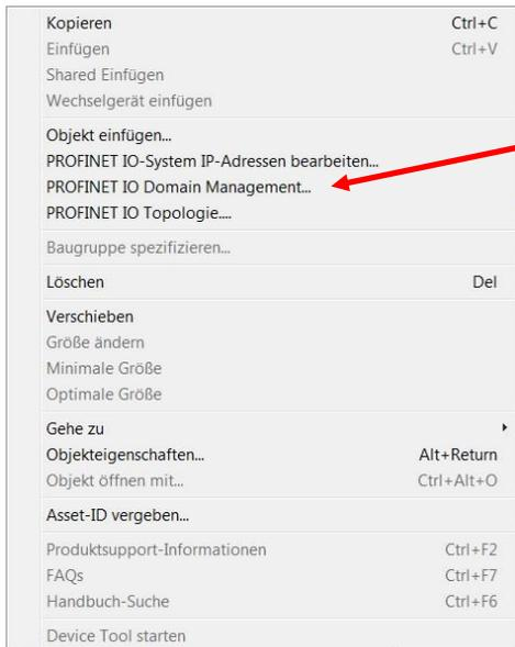
In Fenster „Domain Management“ kann der Name der Sync Domain und der gewünschte Sendetakt eingegeben werden. Der Sendetakt gilt für den Controller und alle Devices, die dieser Sync Domain angehören, und ist mit entscheidend für die Performance des Gesamtsystems.
