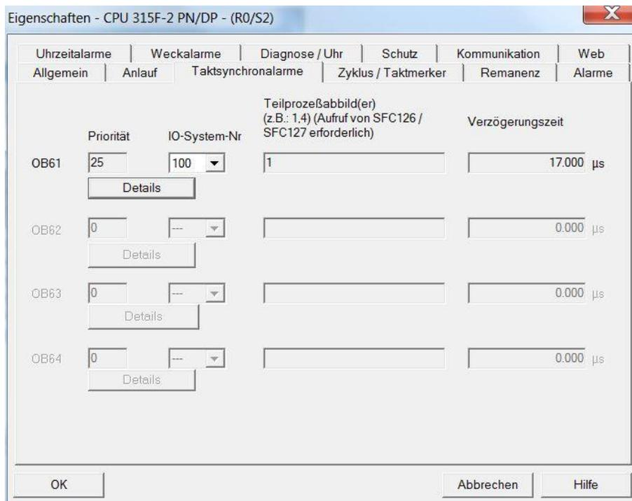
Mit dem Button „Details“ gelangt man zu den Eigenschaften des Taktsynchron-OBs 61. Diesem wird das Teilprozessabbild 1 zugeordnet.
